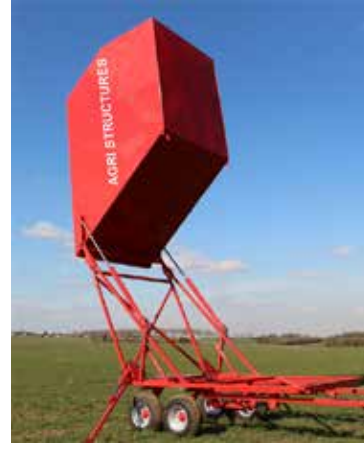
Benne pour vidange en bout de champ ou transbordeur permettant une vidange dans une benne pour éviter chantier de reprise (photos AGRISTRUCTURES)
