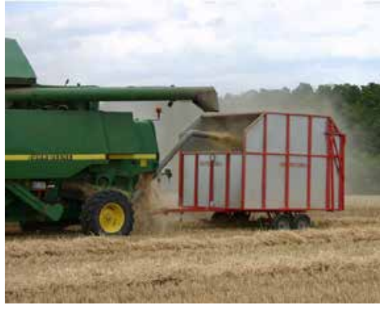
Benne pour vidange en bout de champ ou transbordeur permettant une vidange dans une benne pour éviter chantier de reprise (photos AGRISTRUCTURES)
