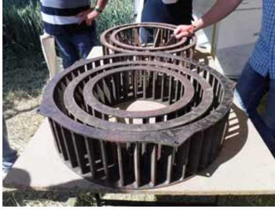
Le dispositif de rotor qui écrase les graines d'adventices avant de les rejeter (photo DRIAAF-SRAL)
