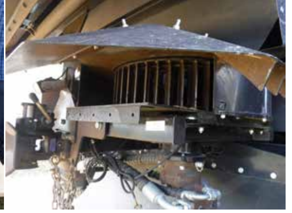
Le dispositif de rotor qui écrase les graines d'adventices avant de les rejeter (photo DRIAAF-SRAL)
